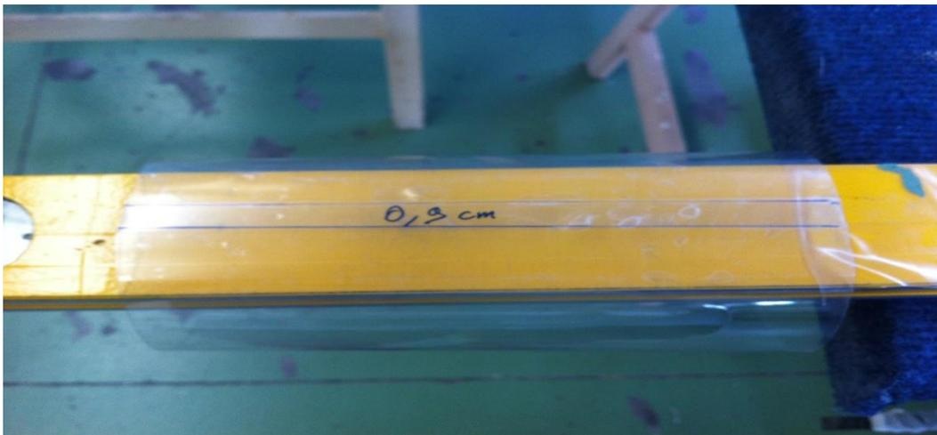
Segna 9mm sul lato dello sviluppo del cono poi sormonta e nastra con scotch trasparente.
